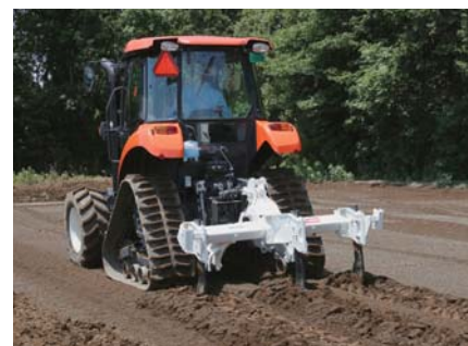
▲サブソイラ：硬盤破碎や簡易暗きよの施工により、地下排水の向上
