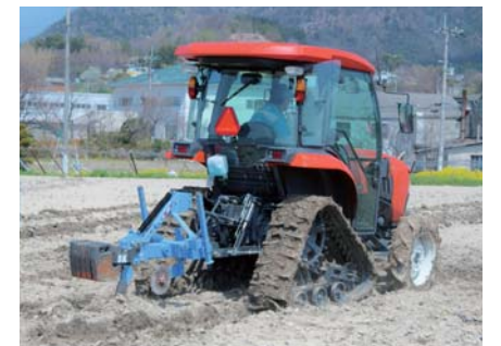
▲穿孔暗きよ機：本暗きよの代替え、深さ40~50cmの施工
