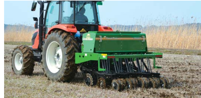
▲グレートプレーンズ不耕起汎用ドリル(乾田直播での播種風景)
