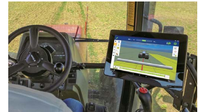
▲自動操舵補助システム(オートステアリング)
