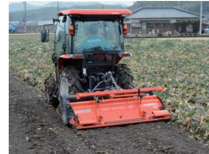
▲碎断ロータリ：作物残草のすき込み(緑肥のすき込みにも有効)
