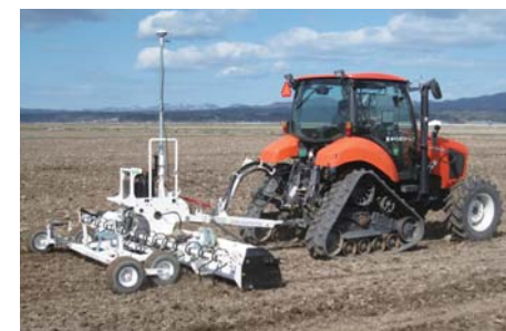
▲GPS レベラーによる田面の均平
