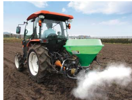
▲車速連動ブロードキャスト：車速が変わっても肥料の散布量を一定に保つ
