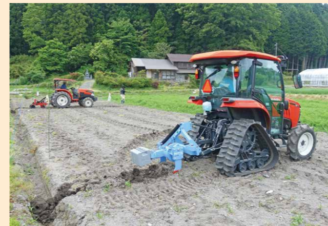
▲破碎部と堅密部があることで、適度な通気性と保水性、排水性の土層がいすれかに確保され、湿害と干ばつの両方に対応できる全く新しい施工方法です。写真手前はカットブレーカー mini
