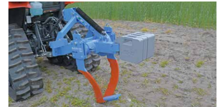
▲全層心土破碎機カットブレーカー mini (株式会社 コーキ・CKBS-04: 適応馬力20~50PS)
